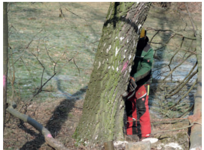
Foto 80: Der Fallkerb wird auf der Seite angelegt, in die der Baum später umgelegt wird. (Foto: A. Stowasser)
