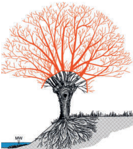
Abbildung 59: Markierung der beim ersten Schnitt abzusetzenden Kronenbereiche
