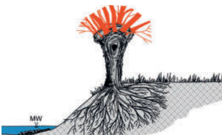
Abbildung 60: Im zweiten Arbeitsgang werden die Astansätze glatt und so nah wie möglich am Weidenkopf nachgeschnitten.
