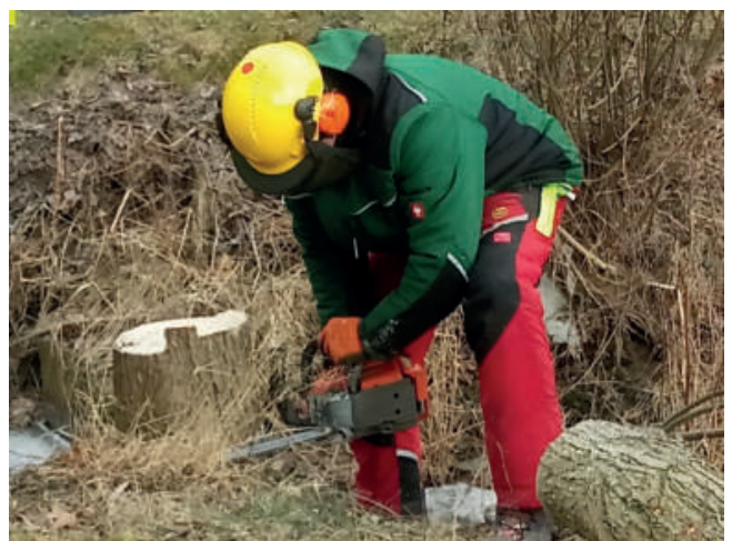
Foto 88: Der Schnitt ist glatt und parallel zur Böschung zu führen. (Foto: A. Stowasser)
