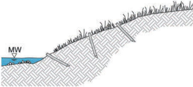
Abbildung 20: Weidensteckhölzer, Länge ca. 60 - 100 cm, Durchmesser 2 - 6 cm, in Wuchsrichtung angespitzt, in unterschiedlicher Neigung in den Boden einschlagen. (INGBIOTOOLS, 2017)
