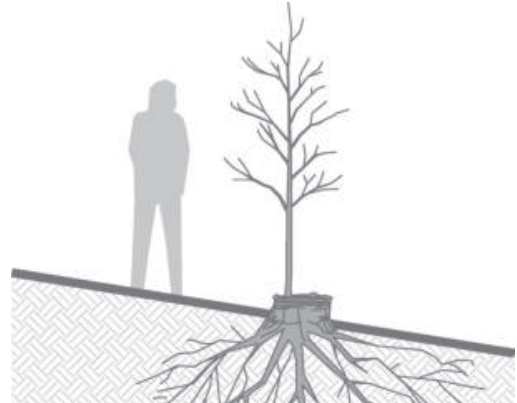
Abbildung 77: Wird ein Einzeltrieb freigestellt, kann sich problemlos ein neuer Baum entwickeln. Vor allem an kleineren Gewässern ist die Freistellung einzelner Triebe zur Förderung eines neuen, durchgehenden Stammes günstig, da stark austreibende und nicht vereinzelt Stockausschläge ggf. den Gewässerquerschnitt stark einschränken können. (vgl. Foto 69)
