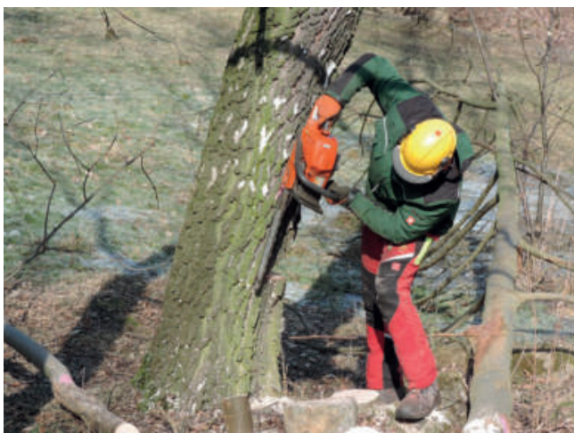
Foto 81: Die Markierung der Stammmitte hilft beim Fällschnitt, nicht in die Bruchleiste zu schneiden. (Foto: A. Stowasser)
