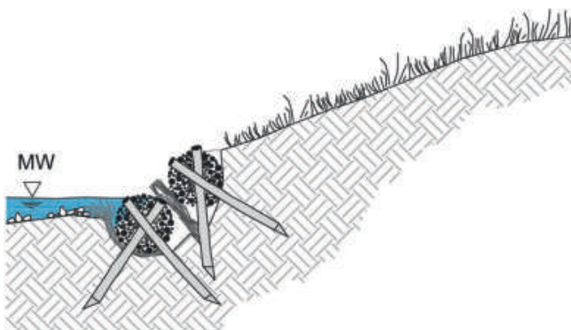
Abbildung 18: Die zweite Lebendfaschine über der Buschlage auflegen und kreuzweise mit je einem Pflöckpaar pro 1m verpflocken. (INGBIOTOOLS, 2017)
