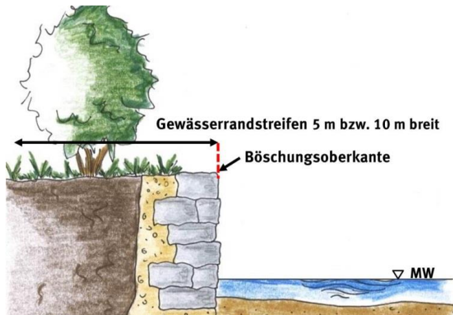
Abb. 9 Ausgebautes Gewässer mit senkrechter Ufermauer als künstliche Böschungsoberkante [Foto: THLG]
